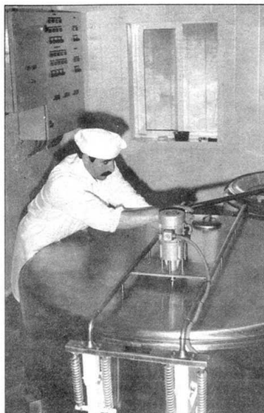
Tanque de refrigeración
